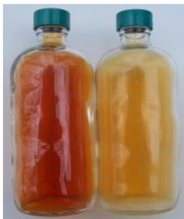
A l'esquerra, mescla amb predomini del \text{NO}_2 . A la dreta, amb predomini del \text{N}_2\text{O}_4 . Wikimedia Commons .
